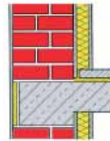
Abb. 16 Außendämmung U-Wert*: 0,46 W/(m 2 K) Einsparung: 69%
