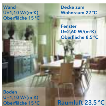
Temperaturen bei einem Gebäude mit schlechter Dämmung (bei Außentemperatur -10 °C)
