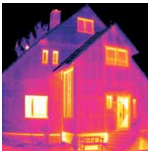
links: Vorgefertigte, mineralfaser-gedämmte Elemente erlauben die zügige, wärmetechnisch einwandfreie Erweiterung des Massivgebäudes.
